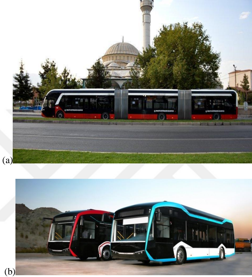
Şekil 1.1 : (a) enerjisini dışarıdan alan ve (b) pil sistemi olan yerli üretim elektrikli toplu taşıma araçları [17].
