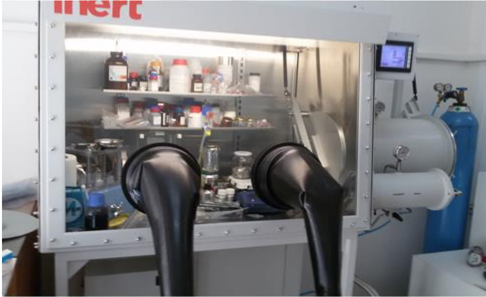
Şekil 2.6 : Pil bileşenlerini bir araya getirirken kullanılan içerisinde argon gazı bulunan glove- box.
