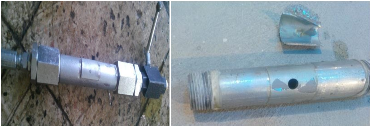
Şekil 6. Deney düzeneği a) tamir edilmiş b) hasara uğramış
