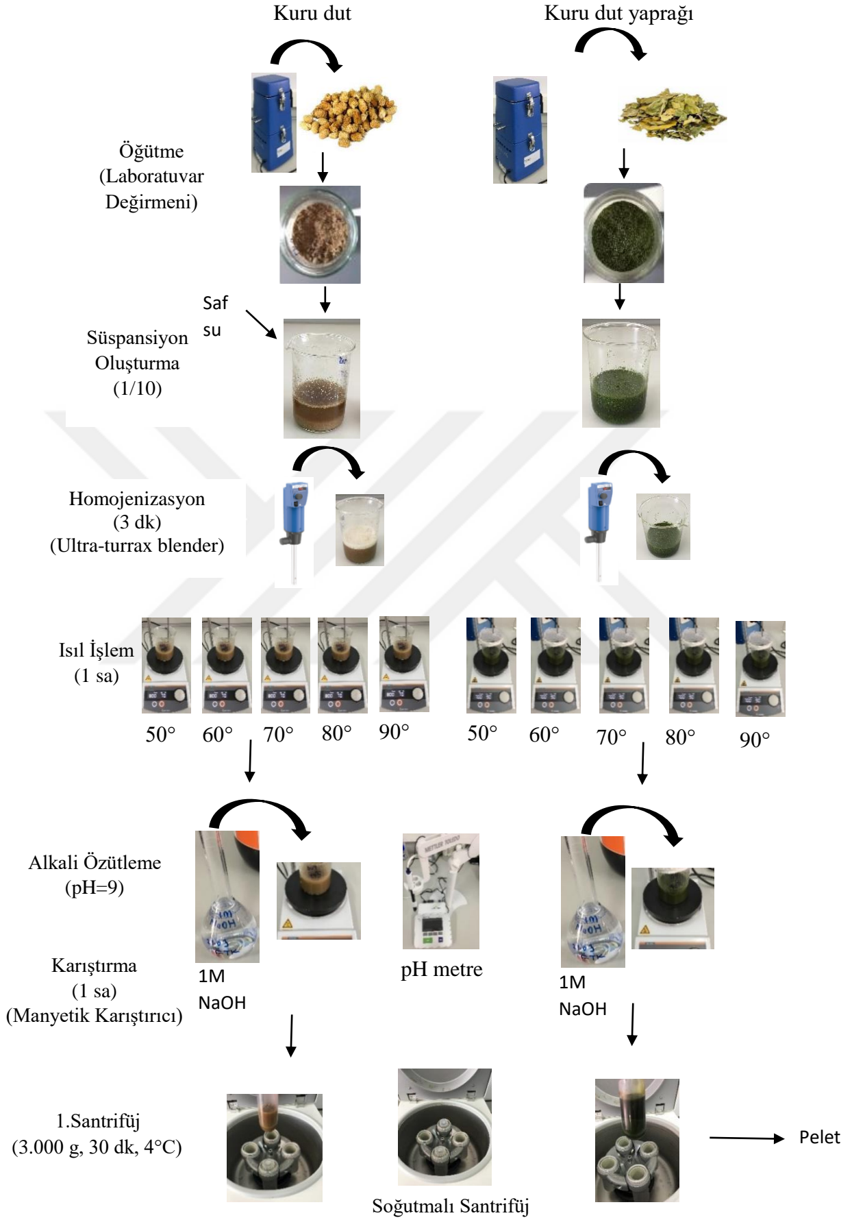
Şekil 3.2: Isıl işlem uygulanan örnekler için protein ekstraktı eldesi akım şeması.
