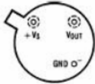
Şekil 3.3a Metal kutulu paket TO-46, alttan görünüşü
