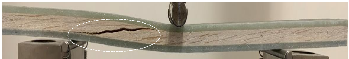
Şekil 4.53 B6-C[±45°] 6 kodlu numunenin eğilme yükü altındaki hasar görüntüsü.
