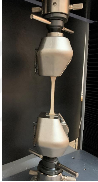
Şekil 3.33 Balsa odununa uygulanan çekme testi.
