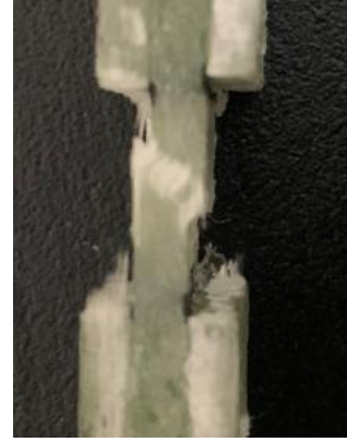
Şekil 4.8 [0^\circ]_8 kompozit numunelerin basma testi sonrası a) üst, b) yan görüntüleri.
