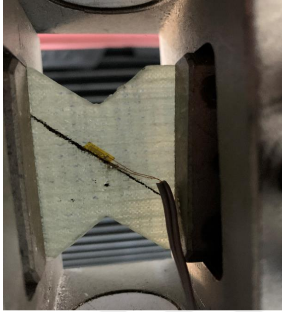
Şekil 3.23 Tek eksenli kompozit numunenin kayma modülü tespiti.
