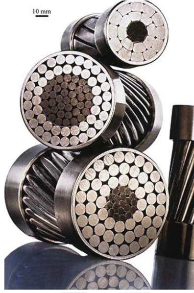
Şekil 2.3 Metal matris kompozitlerin kullanıldığı güç iletim kabloları [66].
