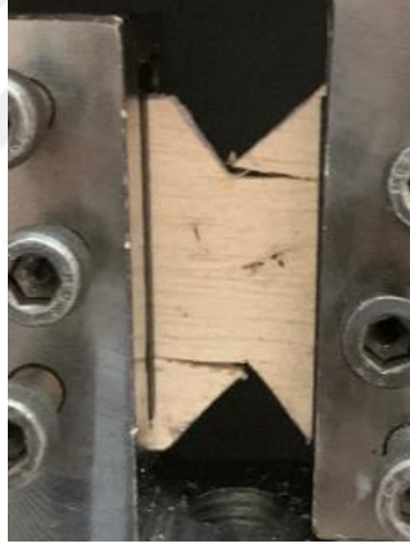
Şekil 4.18 6 mm balsa numunenin kayma testi sonrası hasar görüntüsü.
