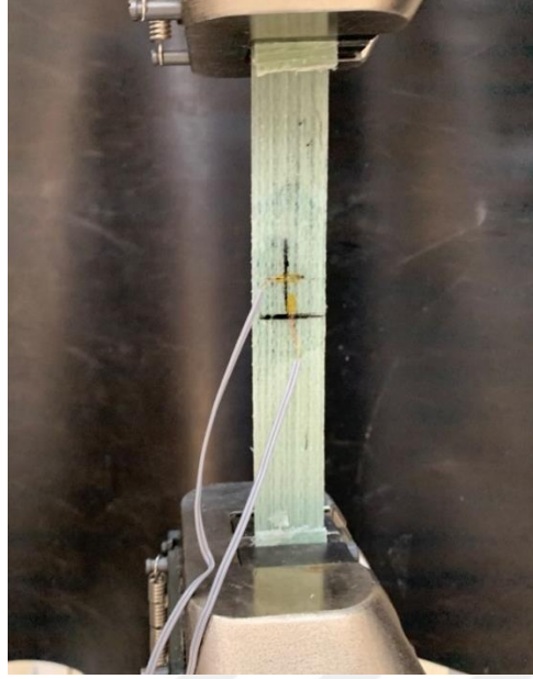
Şekil 3.17 0° yönlenme açılı 8 tabakalı kompozitlerin elastisite modülü ve poisson oranı tespiti.
