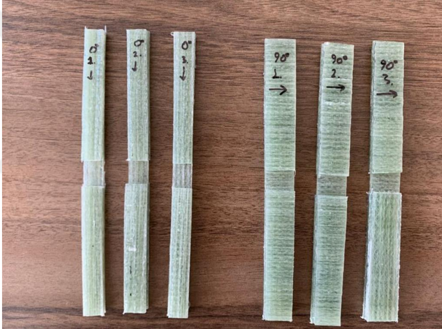
Şekil 3.25 Tek eksenli kompozitlerde lif doğrultusunda ve life dik doğrultuda hazırlanan basma numuneleri.
