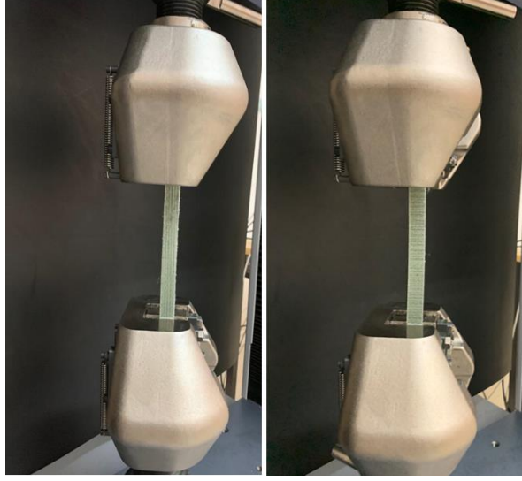
Şekil 3.15 a) 0° yönlenme açılı 8 tabakalı çekme numunesi b) 90° yönlenme açılı 8 tabakalı çekme numunesi.
