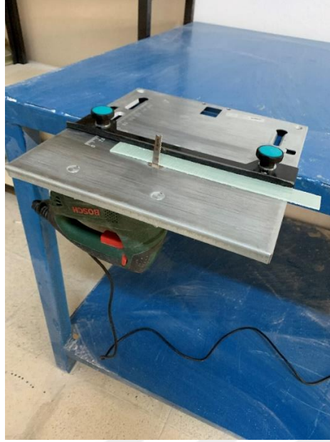
Şekil 3.8 Kompozit ve sandviç malzemelerin kesim işleminin gerçekleştirildiği dekapaj makinesi.
