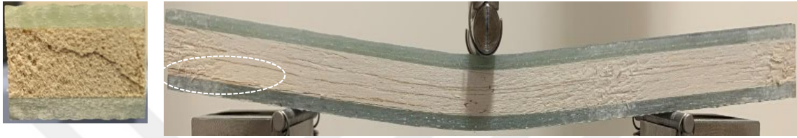
Şekil 4.44 B10-C[0°] 12 kodlu numunenin eğilme yükü altındaki hasar görüntüsü.
