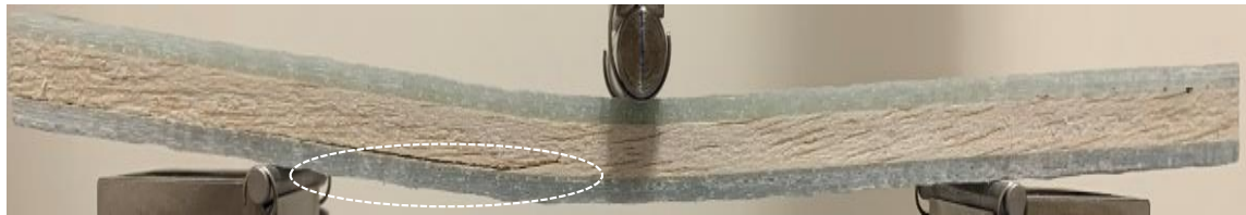
Şekil 4.48 B6-C[0/90°] 6 kodlu numunenin eğilme yükü altındaki hasar görüntüsü.
