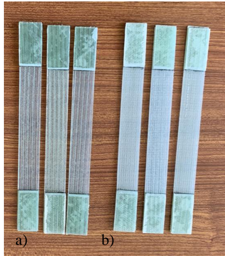
Şekil 3.19 a) [\pm 45^\circ]_4 ve b) [0/90^\circ]_4 yönlenme açılı çekme numuneleri.
