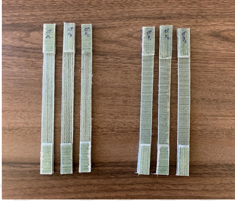
Şekil 3.13 Elyaf doğrultusunda ve elyafa dik doğrultuda hazırlanan çekme numuneleri.
