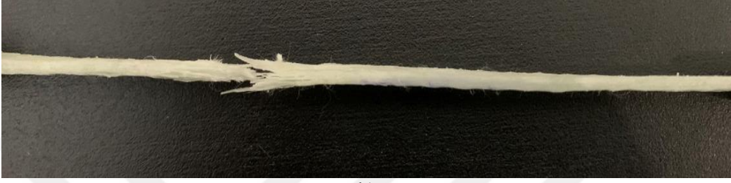
Şekil 4.7 [\pm 45^\circ]_4 kompozit numunelerin çekme testi sonrası a) üst, b) yan görüntüleri.
