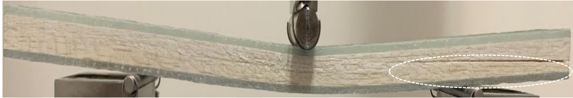
Şekil 4.46 B8-C[0/90°] 4 kodlu numunenin eğilme yükü altındaki hasar görüntüsü.
