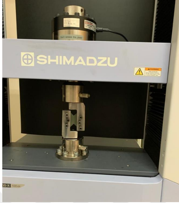
Şekil 3.21 Kayma mukavemetinin belirlenmesinde kullanılan çene aparatı ve test düzeneği.
