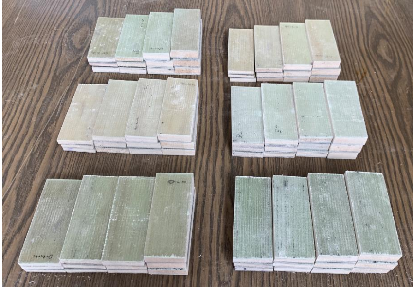
Şekil 3.47 Kenar basma testinde kullanılan sandviç numuneler.
