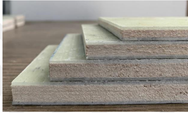
Şekil 3.45 Dış yüzeylerde [\pm 45^\circ]_4 kompozitlerin kullanıldığı, balsa çekirdekli darbe test numuneleri.
