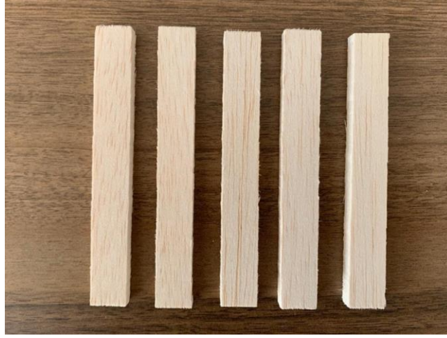
Şekil 3.34 Eksenel basma testi için hazırlanan balsa numuneleri.
