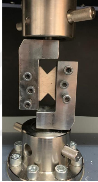
Şekil 3.37 Balsa odununa kayma testinin uygulanması.
