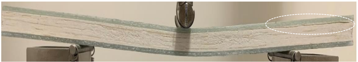
Şekil 4.42 B8-C [0^\circ]_8 kodlu numunenin eğilme yükü altındaki hasar görüntüsü.
