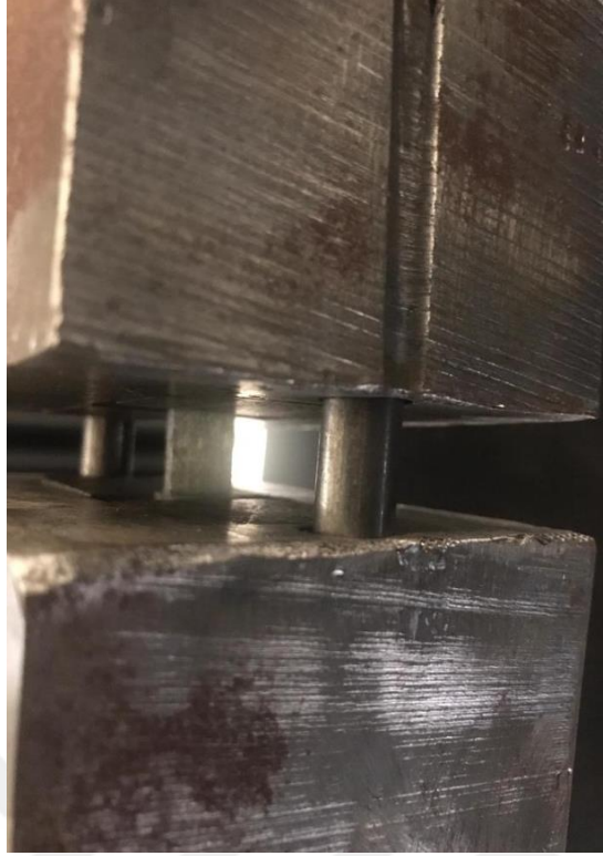
Şekil 3.28 Kompozit numunelere basma testinin uygulanması.
