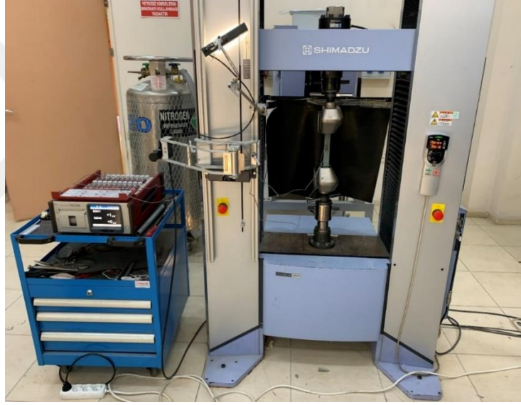
Şekil 3.16 Stain gauge kullanılarak ölçüm yapılan çekme test sistemi.
