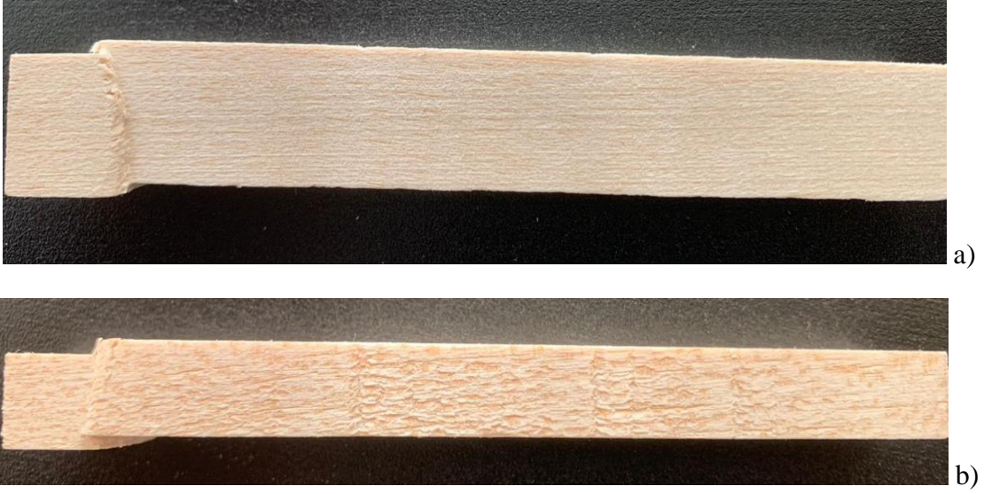
Şekil 4.17 10 mm balsa numunenin kenar basma testi sonrası a) üst, b) yan görüntüleri.
