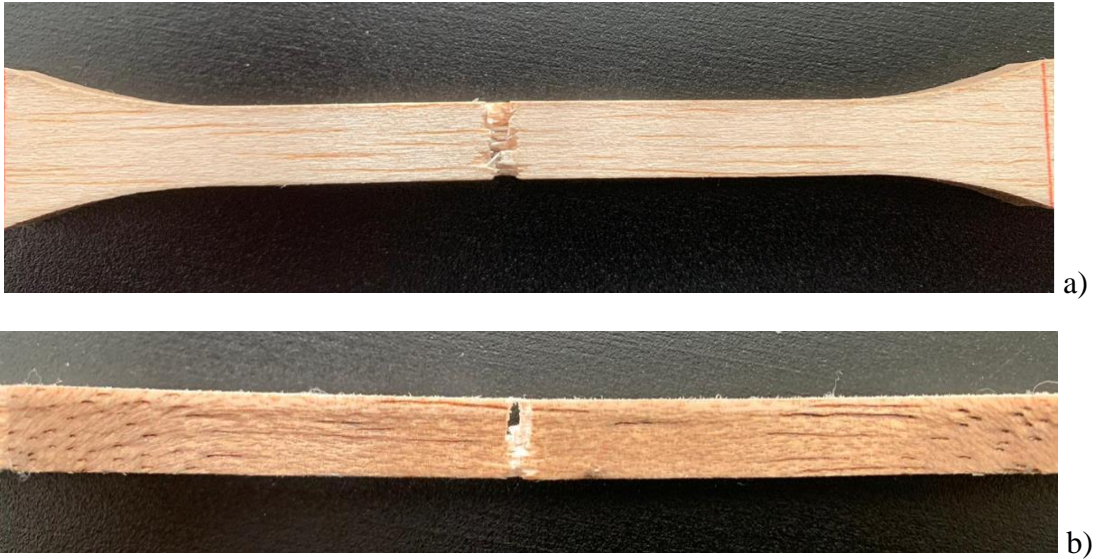
Şekil 4.16 8 mm balsa numunenin çekme testi sonrası a) üst, b) yan görüntüleri.
