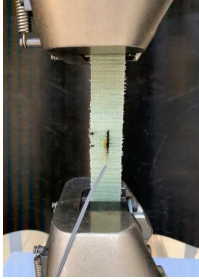
Şekil 3.18 90° yönlenme açılı 8 tabakalı kompozit malzemelerin elastisite modülü tespiti.
