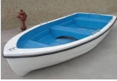
Şekil 2.1 a) Cam fiber gövdeli kayak [51] b) Cam fiber takviyeli Chevrolet Corvette araç kasası [50].
