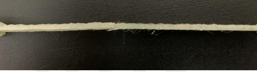
Şekil 4.5 [90^\circ]_8 kompozit numunelerin çekme testi sonrası a) üst, b) yan görüntüleri.
