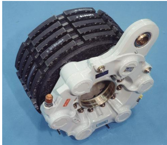
Şekil 2.5 Boeing 767 uçağında kullanılan bir karbon/karbon fren takımı [66].
