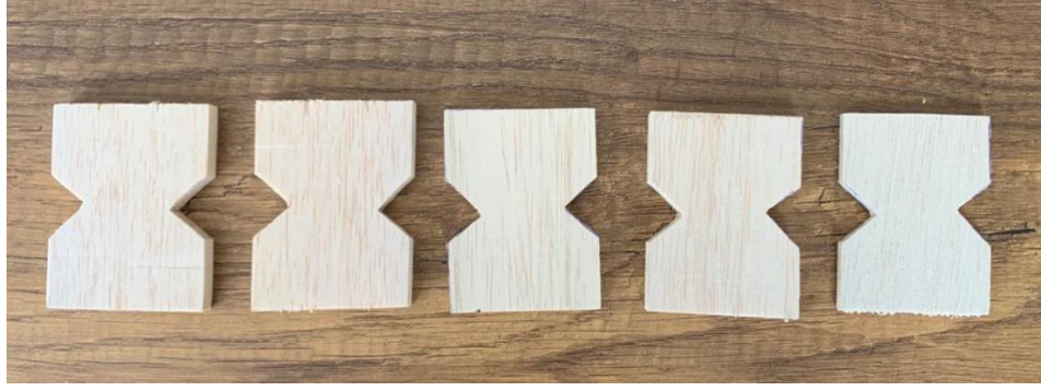
Şekil 3.36 V çentikli balsa kayma numuneleri.
