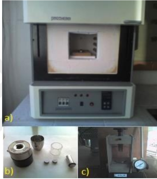
Şekil 4.1. Katıhal reaksiyon methodunda kullanılan aletler (a) Kül fırın (b) Peletleme sistemi (c) Presleme sistemi
