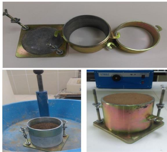
Şekil 5.15: CBR deney aşamaları.
