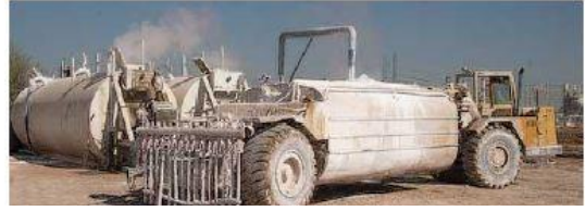
b-Karışımın dağıtıcıya aktarılması
