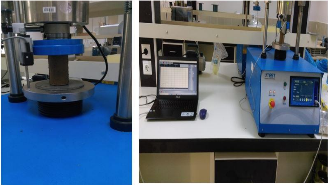
Şekil 5.13: Serbest basınç deney seti.
