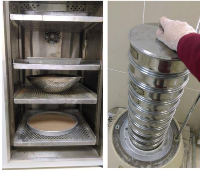
Şekil 5.6: Etüv, elek seti ve sarsma tablası.
