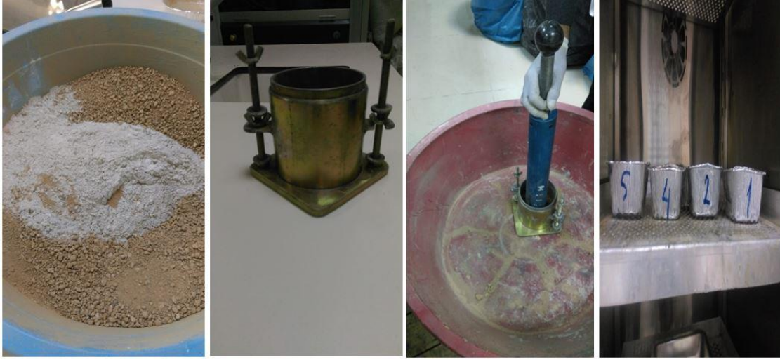
Şekil 5.11: Standart proktor deney aşamaları.
