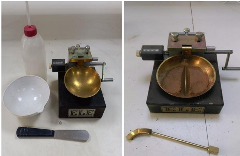
Şekil 5.9: Casagrande deney seti.
