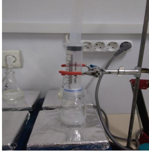
Şekil 3.7. Uçucu yağ/aljinat solüsyonunun \text{CaCl}_2 solüsyonuna damlatılması
