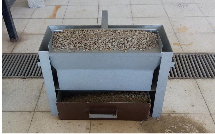
Şekil 3.3 Bıçaklı bölücü (riffle splitter)
