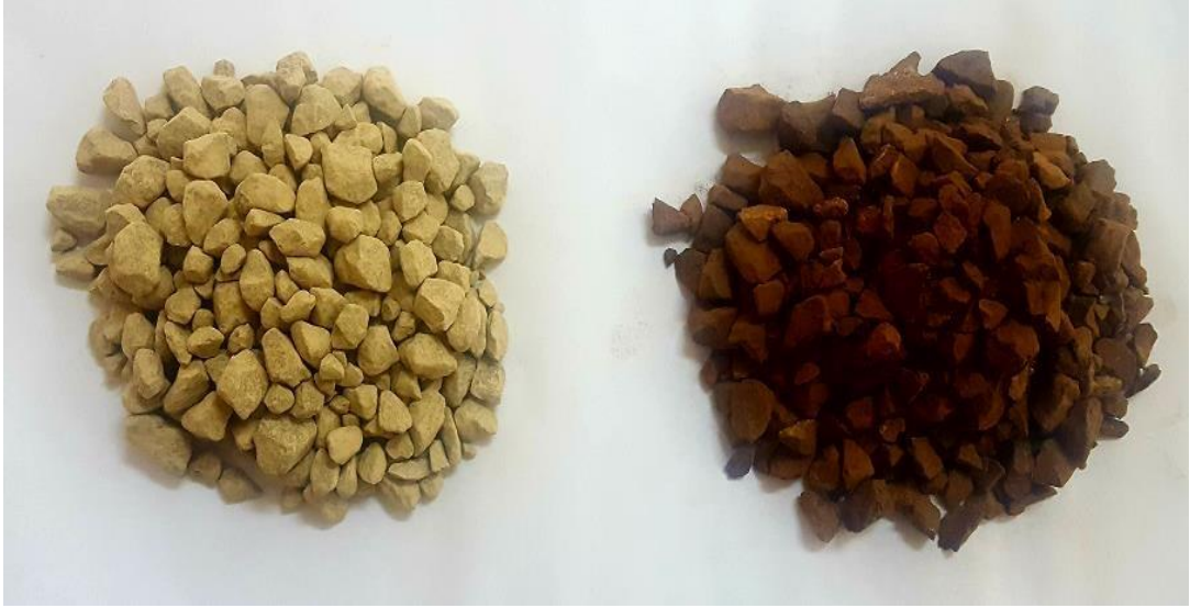
Şekil 3.1 Ham siderite (solda) ve kalsine siderite (sağda) numuneleri
