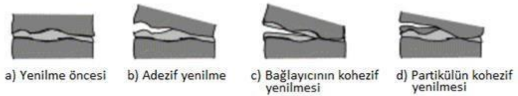
Şekil 2.8 Partikül ve bağlayıcı sistemin yenilme türleri [61]
