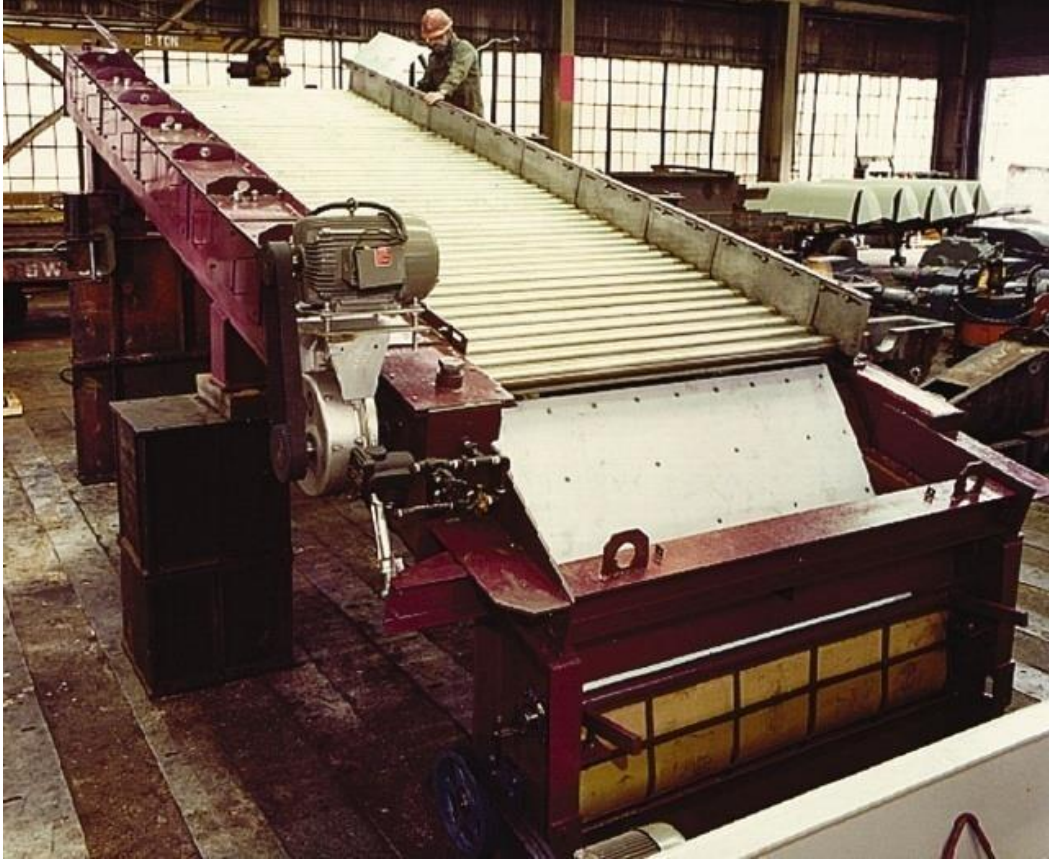
Şekil 2.14 Izgara öncesi rulolu besleyici [69]
