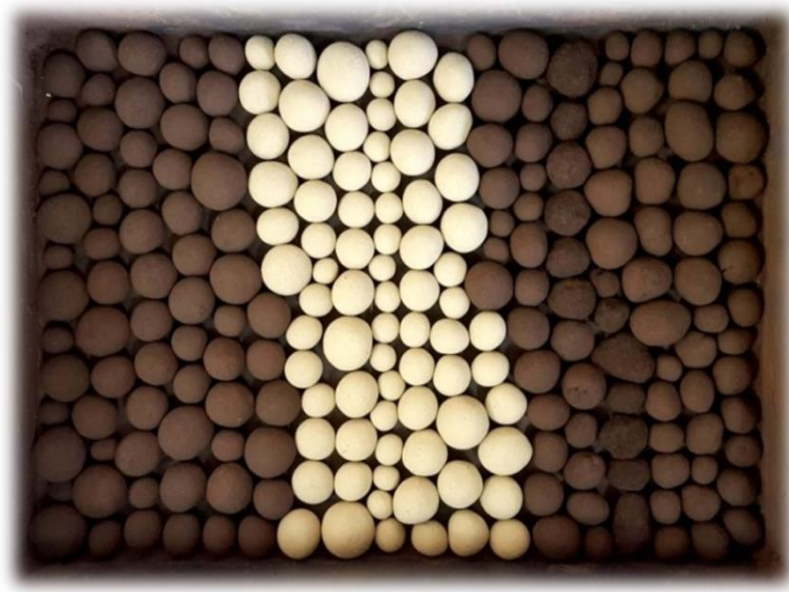
Şekil 3.10 Isıl işlem öncesi ham peletlerin görünümü
