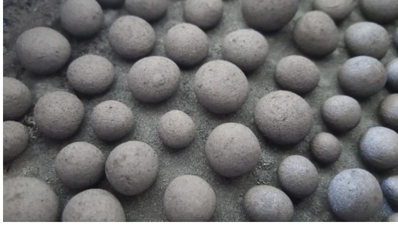
Şekil 3.11 Ürün peletlerin görünümü
