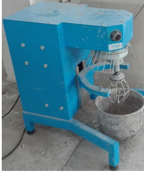
Şekil 3. 4. Beton karışım mikseri
