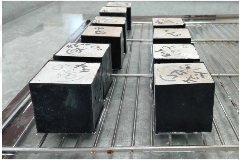
Şekil 3.13. Kılcal geçirimlilik deneyi düzeneğindeki numuneler
