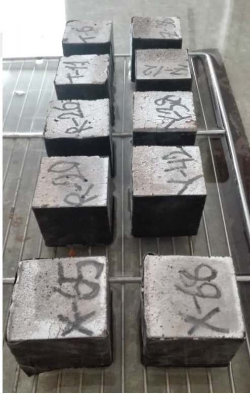
Şekil 4. 18. 800°C sonrası kılcal geçirimlilik deneyi uygulanan numunelerin görünümleri
