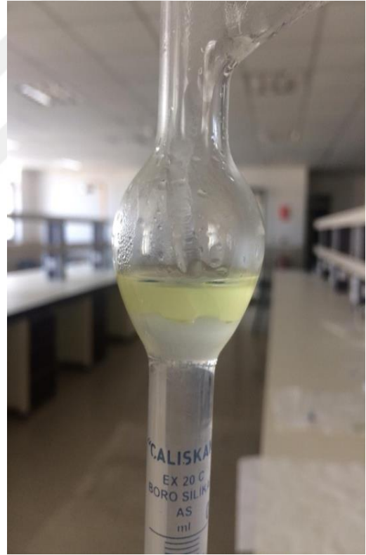
Şekil 3.5 Clevenger aparatı ve soğutucu, Şekil 3.6. Toplama haznesinde biriken esansiyel yağ
