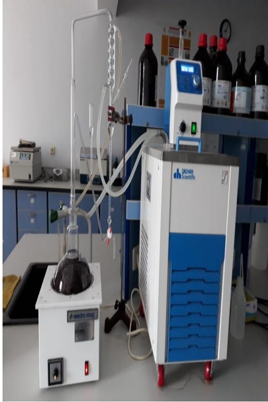
Şekil 3.5 Clevenger aparatı ve soğutucu, Şekil 3.6. Toplama haznesinde biriken esansiyel yağ
